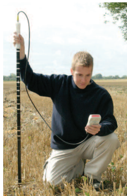
(Sus) Sonda profil PR2/6 cu umidometru HH2. (Dreapta) Sonda profil PR2/4
