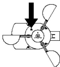
2. Pentru activarea pluviometrului solar, prima dată, scoateți capacul pâlniei prin răsucire, apoi îndepărtați banda de protecție de pe pârghia basculantă și folia neagră de protecție a panoului solar
